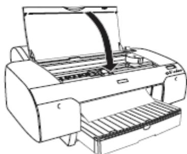
9. Mettez le levier de maintien du papier en position fermée. Le papier avance automatiquement jusqu'à la position d'impression.
