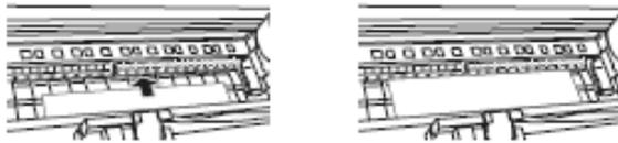
7. Alignez le côté droit du papier sur la ligne indiquée par le repère en forme de flèche et alignez le côté inférieur du papier sur la ligne portant la mention du format de papier utilisé sur le bac papier. Si le format du papier utilisé est Letter, A4 ou B4, alignez le bord du papier sur LTR/A4/B4. Si le format du papier utilisé n'est pas mentionné ci-dessus, alignez le bord du papier sur AUTRES.
